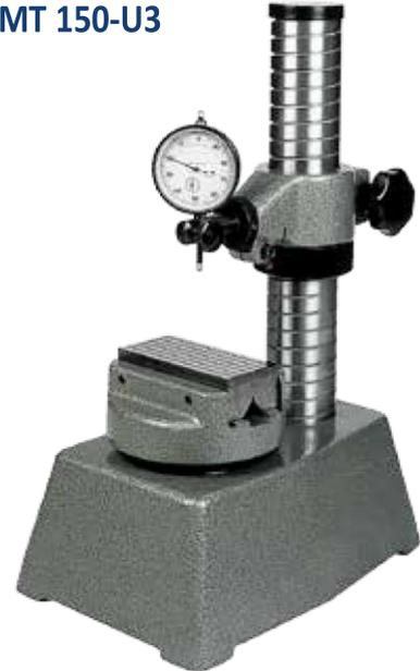
Die Messuhrenaufnahmen sind auswechselbar
