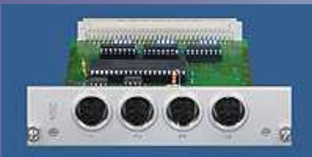
MSC Modul für bis zu 4 Messgeräte mit Sylvac Ausgang
