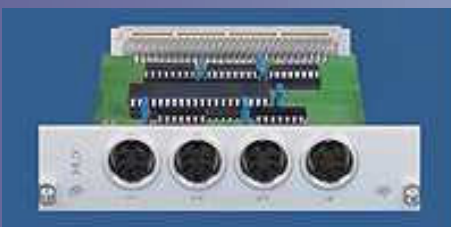
MUX Umschaltkarte für bis zu 4 induktive Messtaster
