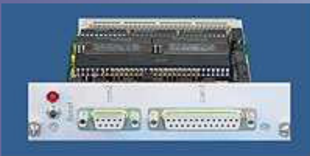
CPU2 Prozessorkarte mit höherer Leistung
