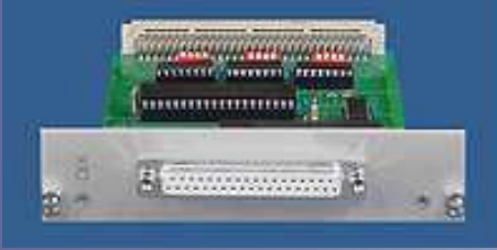
CEK Digitale Eingabekarte mit CMOS-Hochpegel-Eingängen
